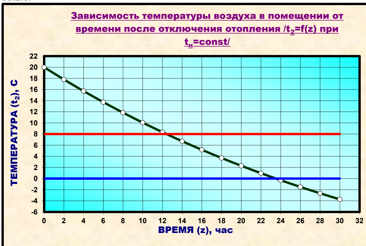
Рисунок 11.2.1 – Зависимость температуры воздуха в помещении от времени после отключения отопления при наружной t_{нар.ж.} = -100С
